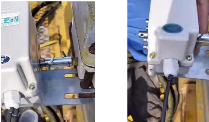
幅度传感器安装示意图
